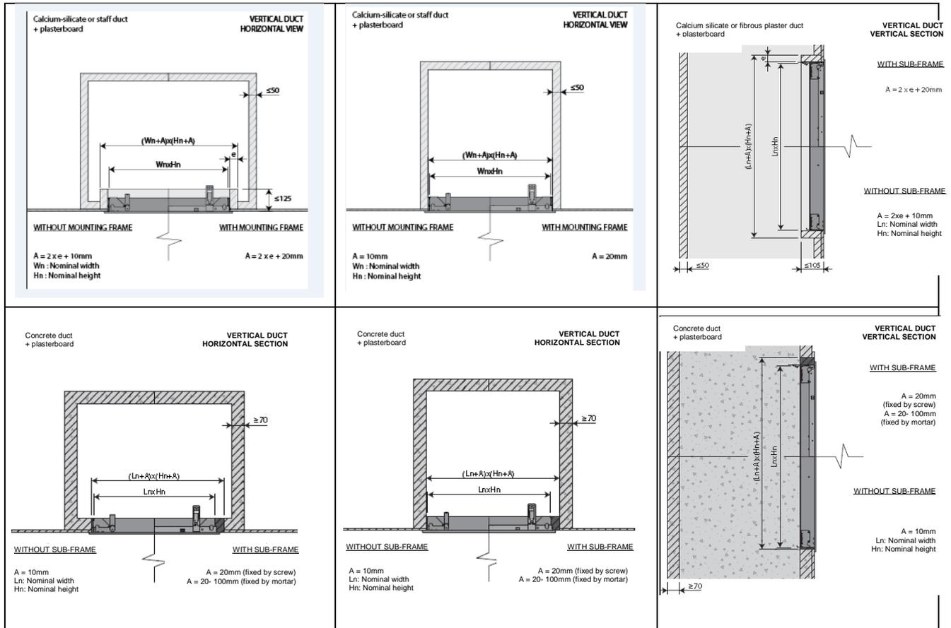
**7.4. IMPLEMENTATION OF A WALL IN FRONT OF THE SLEEVE OR DUCT CONTAINING THE DAMPERS**
